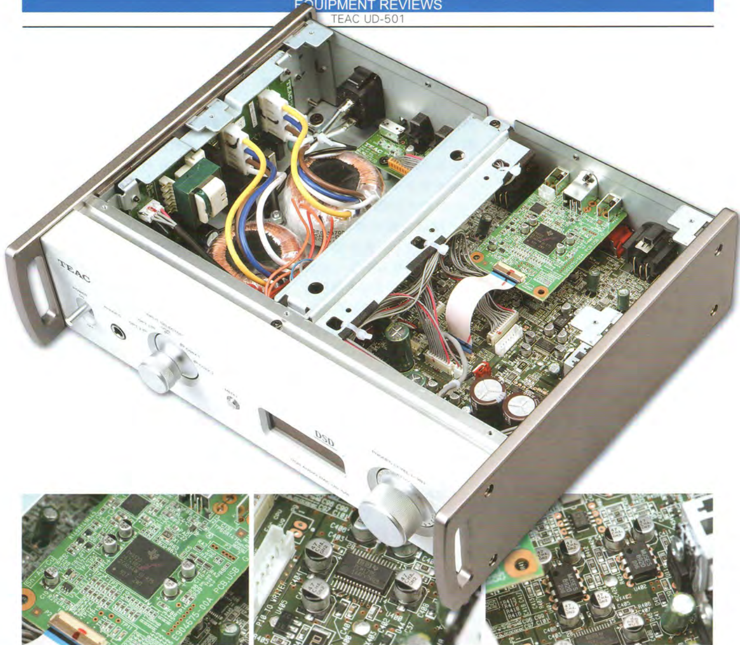
▲上：本機內部的電路複雜而密集，但依然做到Dual Mono配置。 下左：USB接收電路竟然動用TI的TMS320 DSP晶片。 下中：本機的D/A轉換核心是BB 32bit演算的PCM1795，每聲道使用一枚。 下右：每聲道類比電路各使用兩枚JRC最好的Muses8920 OP晶片並聯輸出。
