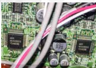
▲採用雙AKM AK4490，左右聲道各一組DAC，不僅如此，DAC與前級放大部分均採取全平衡設計。
