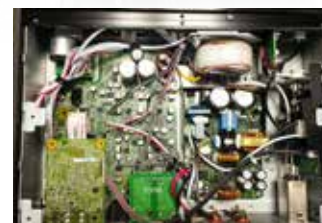
▲機內電路布局紮實，ICE power與環型變壓器分開供電，能夠獲得更高的音質純淨度。
