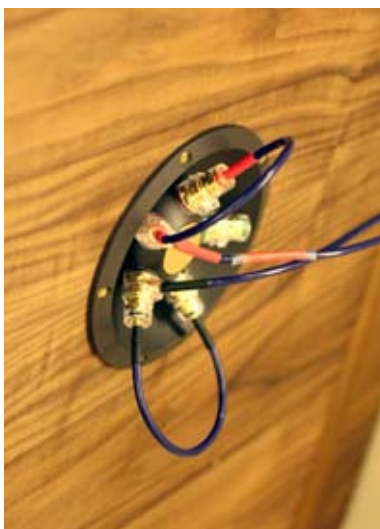
Tannoy 新的喇叭線接端都是五點設計，其中第五點就是接地點。
