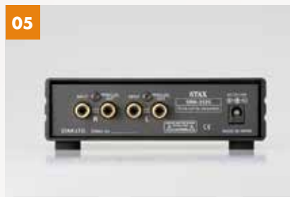
05 背板輸出具有一組RCA輸入及並聯輸出，並聯輸出對家中現有的訊源器材來說相當方便，可將輸送至耳擴的類比訊號再輸出給其它器材使用。
